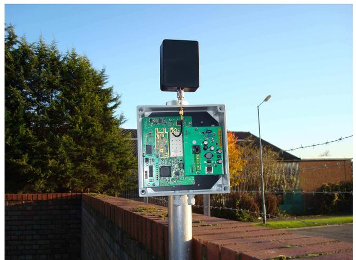
VideoWave® und DigiWave® 5.6 GHz im IP67-Gehäuse geeignet für Aussenanwendungen.
